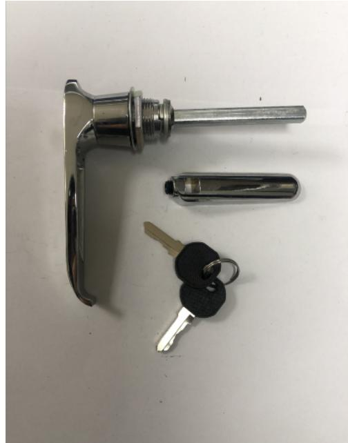
配电箱门锁，包括：座体，锁舌，旋转杆，锁块，暗锁装置以及明锁环，座体用于安装在配电箱箱门上，座体表面凹陷形成供锁块置入的放置槽，座体内侧设置有锁舌，锁舌用于勾住配电箱箱体边缘，锁舌安装在旋转杆一端，旋转杆另一端铰接至锁块一端，锁块用于辅助带动旋转杆旋转，锁块另一端通过暗锁装置与座体可拆卸连接，放置槽中部内壁上安装有明锁环，锁块中部开设有供明锁环穿过的穿孔，明锁环用于通过勾住明锁限制锁块冒出放置槽。配电箱门锁解决现有技术中因暗锁装置复杂而导致暗锁装置损坏后整个门锁均不能使用的问题。
