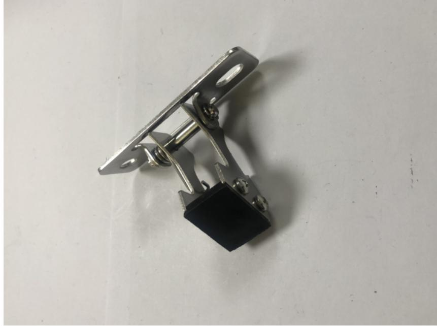
电柜连杆锁安装方法：电柜连杆锁安装方法非常简单，不过这个技能对生产工人有用，对于我们一般的使用者用处不大，因为这个坏的几率几乎为零。下面我就电柜连杆锁安装方法给大家做个介绍。1. 将连杆装入柜门，连杆分上下，大家安装的时候注意观察，不要装反了，装反之后连杆无法对准柜门的上下边缘的孔。2. 安装连接件，这个连接件上面有三个孔，中间是控制孔，链接文件柜锁，两端的小孔连接连杆。一般都是固定死的，使用锤子和砧板，打平连接柱。3. 安装锁具，将电柜连杆插入柜门上下的孔中，安装锁具，并将连接杆上的连接件固定在锁上，之后安装柜门上的限位皮套。这个皮套的作用是防止连接杆在工作过程中掉入柜门里面。机械锁无需用电，即使停电，机械锁还是“我行我素”各干各的。喷涂电柜门锁现价
